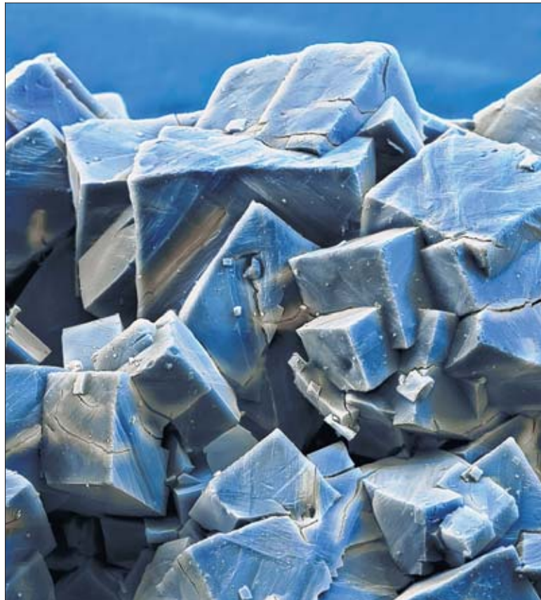
Nanometergroße Würfel aus Metall-Kohlenstoff-Verbindungen (l.) sind zukünftige Treibstoffspeicher. Nano-Zinkoxidpigmente reflektieren UV-Licht, färben aber nicht die Haut
